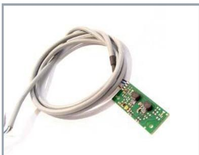
L'Encoder incrementale ad effetto Hall HL901 è un accessorio utilizzato per il controllo di posizione e/o di velocità di qualsiasi motore elettrico. I segnali prodotti dall'Encoder HL901 possono essere portati in ingresso di qualsiasi centralina per controllo motori che ne preveda l'utilizzo.
